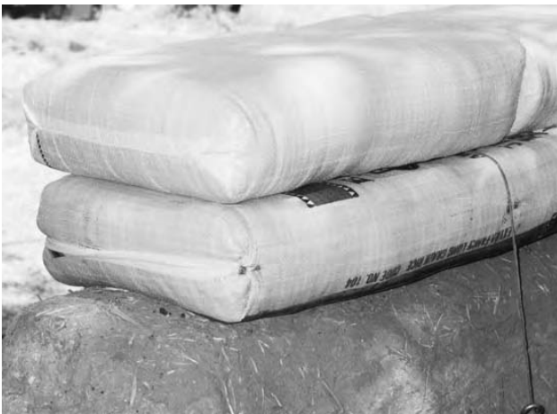
3.6: Sac expandabil cu pliuri deasupra unui sac cu colțurile ascunse și asigurate. Odată cu apariția sacilor cu pliuri, ascunderea colțurilor ar putea deveni o artă pierdută.
