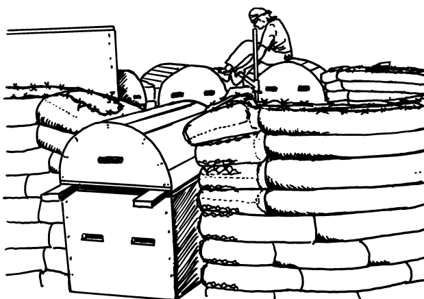
12.20: Încorporați sârma ghimpată de la perete între toți sacii evantai din jurul formelor arcuite, așa cum este arătat în ghidul ilustrat pas-cu-pas și integrați tuburi cu saci pe lângă forme.
