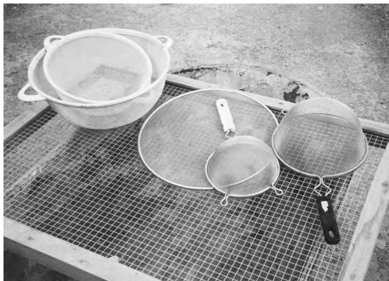
15.6: Noi practicăm un stil cu adevărat rustic de tencuială, folosind, în principiu, o strecurătoare de bucătărie de sârmă de dimensiuni între 0,1 și 0,3 centimetri pentru cernerea tencuielilor de finisare.
