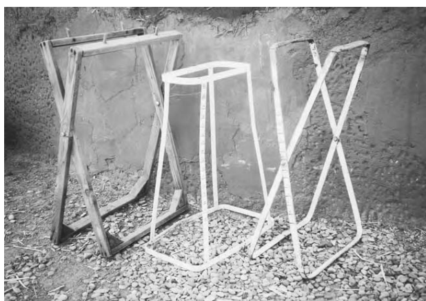
3.2: Varietatea evolutivă a stivelor pentru saci. De la stânga la dreapta: lemn pliabil; metal rigid sudat; și preferatul nostru, cel pliabil fără sudură.
