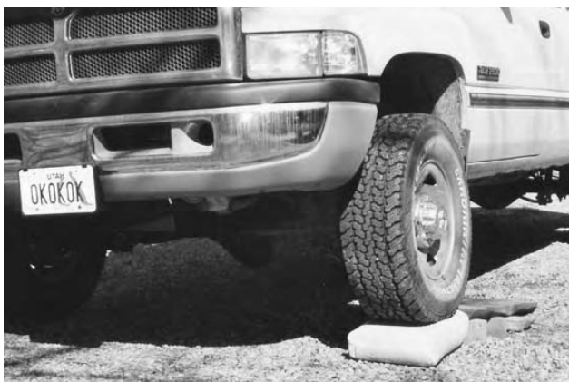
2.10: Acest test informal demonstrează că un sac bine întărit poate prelua greutatea unei camionete de 3,5 tone, fără modificări structurale.
