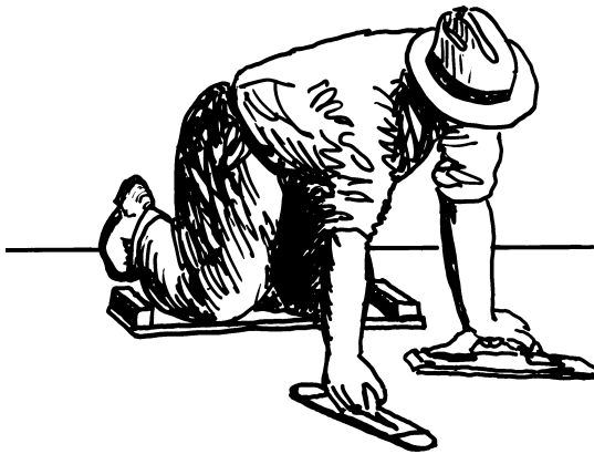
16.7: Sfat pentru podeaua finisată cu mistria: o placă va proteja și podeaua, și genunchii voștri. Susținerea greutății voastre pe o placă de lemn vă eliberează cealaltă mână pentru a folosi mistria cu același grad de presiune.
