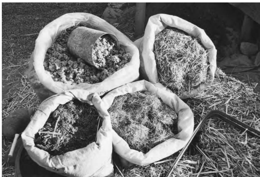
14.4: O varietate de fibre bine asortate pentru tencuială: în sensul acelor de ceasornic, începând cu partea de sus-stânga; celuloză din hârtie, paie tăiate, paie lungi (pe jos), bucăți de iarbă decolorate și bălegar de cal.
