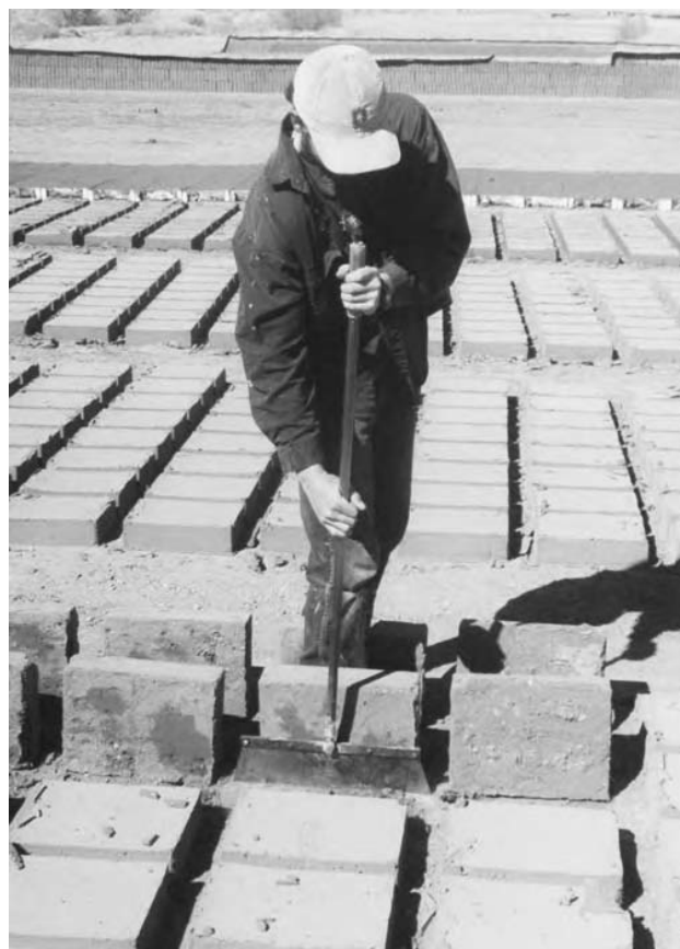
1.4: Curățarea chirpiciului la Stația de Chirpici Rio Abajo, Belen, New Mexico
