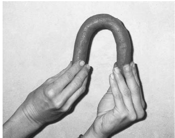
2.2: O argilă de calitate poate fi modelată cu foarte puține fisuri.
