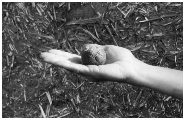
2.6: Strângeți puțin pământ în mână. Ar trebui să fie destul de umed pentru a se compacta într-o bilă.
