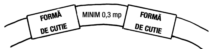
5.13: Pentru un perete curb, calculați 0,3 mp între deschideri măsurând pe partea interioară a peretelui.
